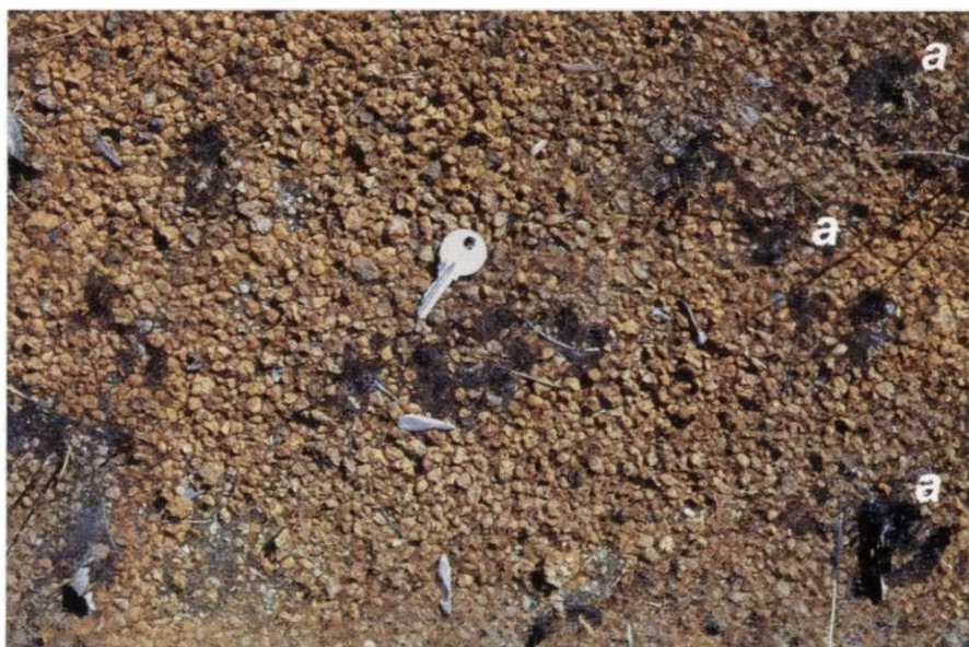
Fig. 43.- Dépôt de fer pulvérulent sur des gravillons, résultant de la dessiccation de fer colloïdal précipité à partir d'une arrivée d'eau riche en fer par affleurement de la nappe aquifère. D'autres dépôts forment des pellicules (a) sur un feutrage végétal. Ces dépôts, après une longue dessiccation, ne donnent aucune réponse à l'analyse aux rayons X.
