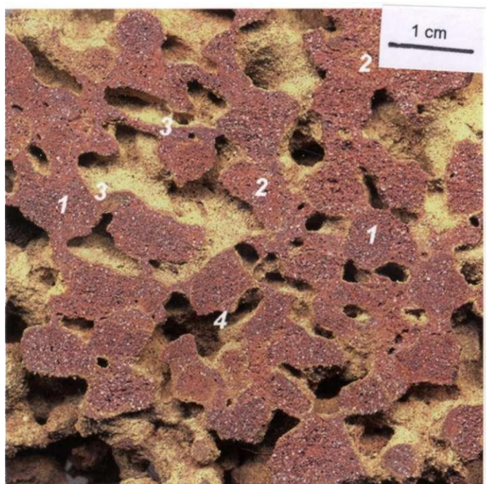
Fig. 29.- Faciès gravillonnaire 1 (B101) Kisa Moya 1. Des concrétions sableuses de deux générations: la première (1) a été dégagée de l'horizon tacheté où elle s'est formée par le ruissellement; la seconde (2) contient des éléments fins provenant du Précambrien sous-jacent et leur remontée implique le travail des termites, termites qui sont eux-mêmes responsables des galeries (4). Un léger enduit (3) forme des ponts entre les concrétions, dans une structure intertextique. Cas assez complexe et rare de la transformation d'un faciès gravillonnaire en faciès nodulaire.
