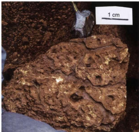
Fig. 46.- Carapace dont la cohésion est due principalement à la rigidité conférée à l'ensemble par un réseau de galeries tapissées de fer.
