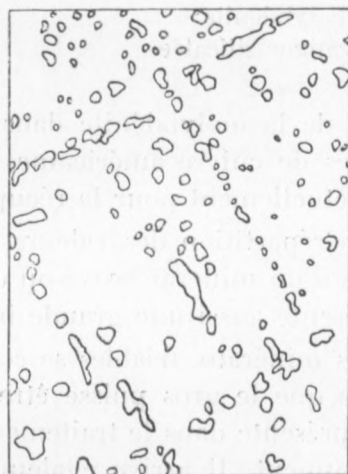
FIG. 15. — Inclusions de chalcopyrite dans la blende. \times 270 .
