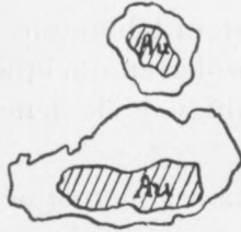
FIG. 11. — Inclusions d'or dans l'altaïte (Pb Te). \times 800 . (Mine Lake Shore.)
