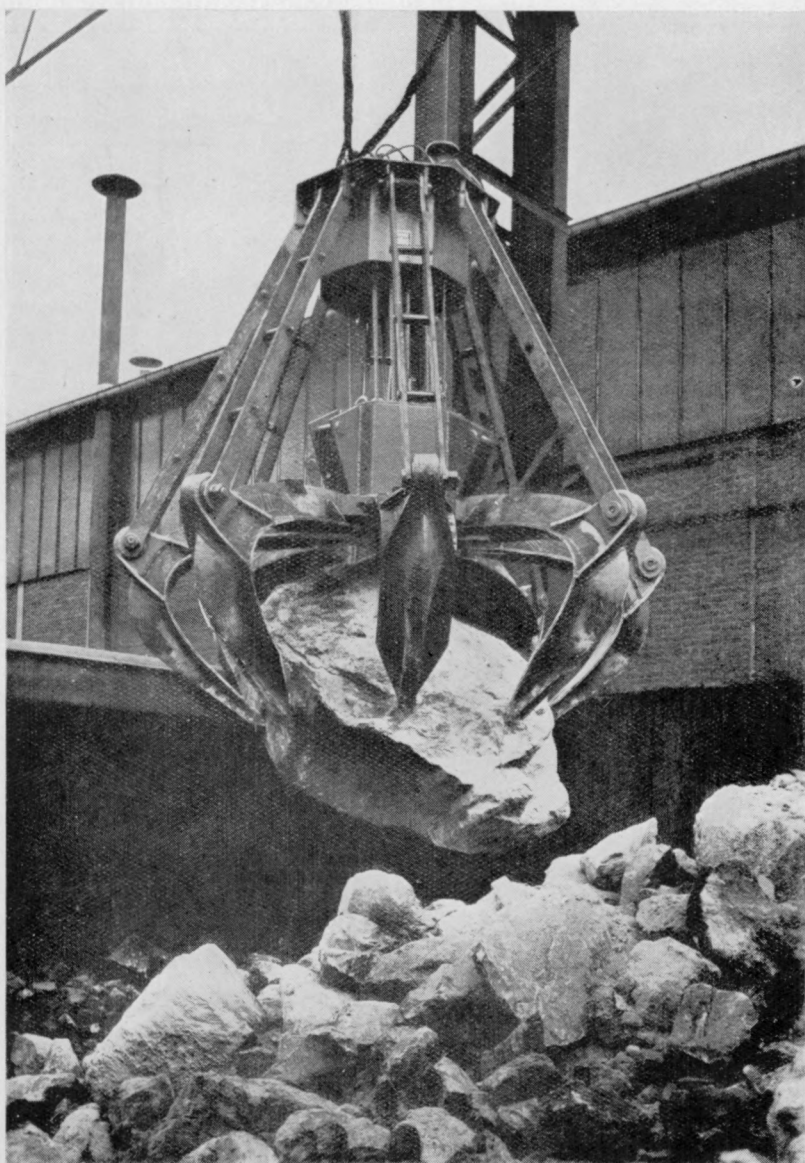
FIG. 30. — Grappin Polyp en essai de réception.
