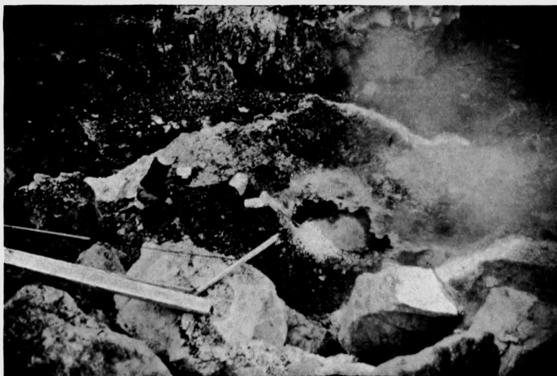
FIG. 9. — Mesure de la température par H. TAZIEFF et P. EVRARD dans l'évent dénommé « Grand Gueulard », ouverture d'un mètre carré environ par où s'échappe sous pression une flamme de 8 à 10 m de longueur.
