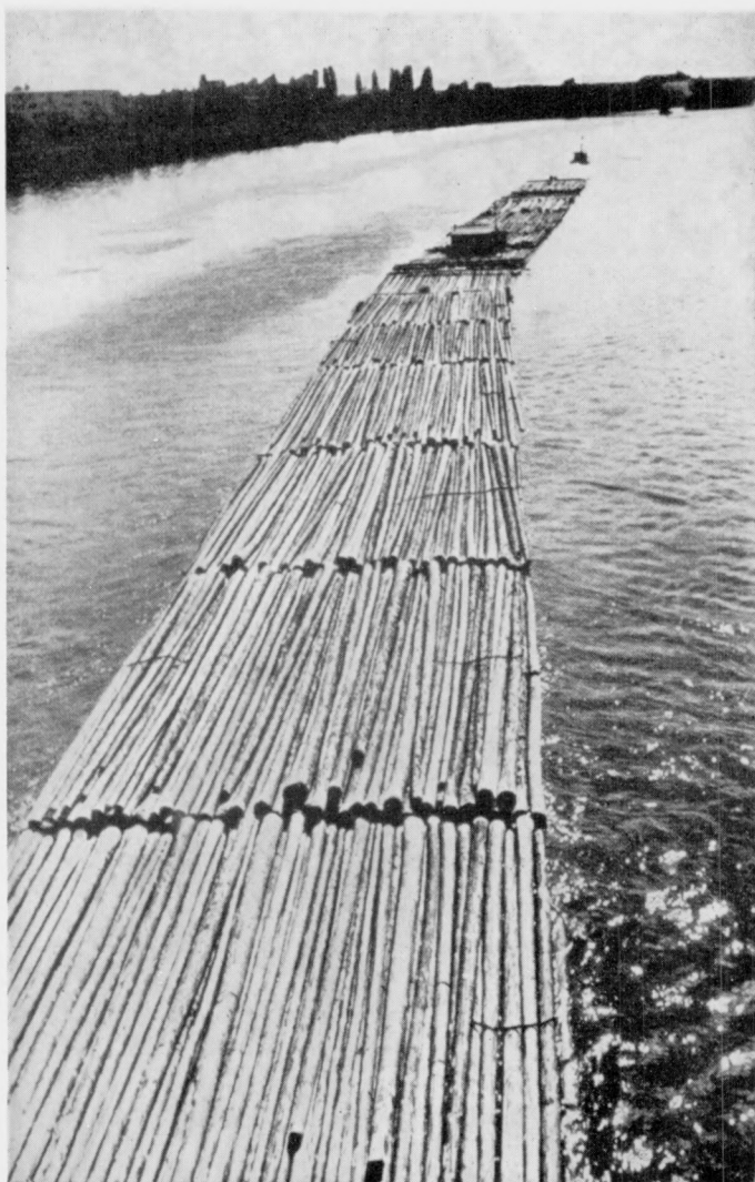
PHOTO 1. — Radeau actuel du Main composé de deux radeaux de 150 m de long remorqués bout à bout ; la largeur est de 9 m.
