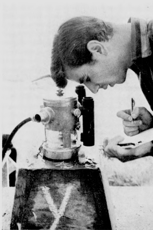
FIG. 5. — Nivellement hydrostatique: pot à eau type IGM/CNV
