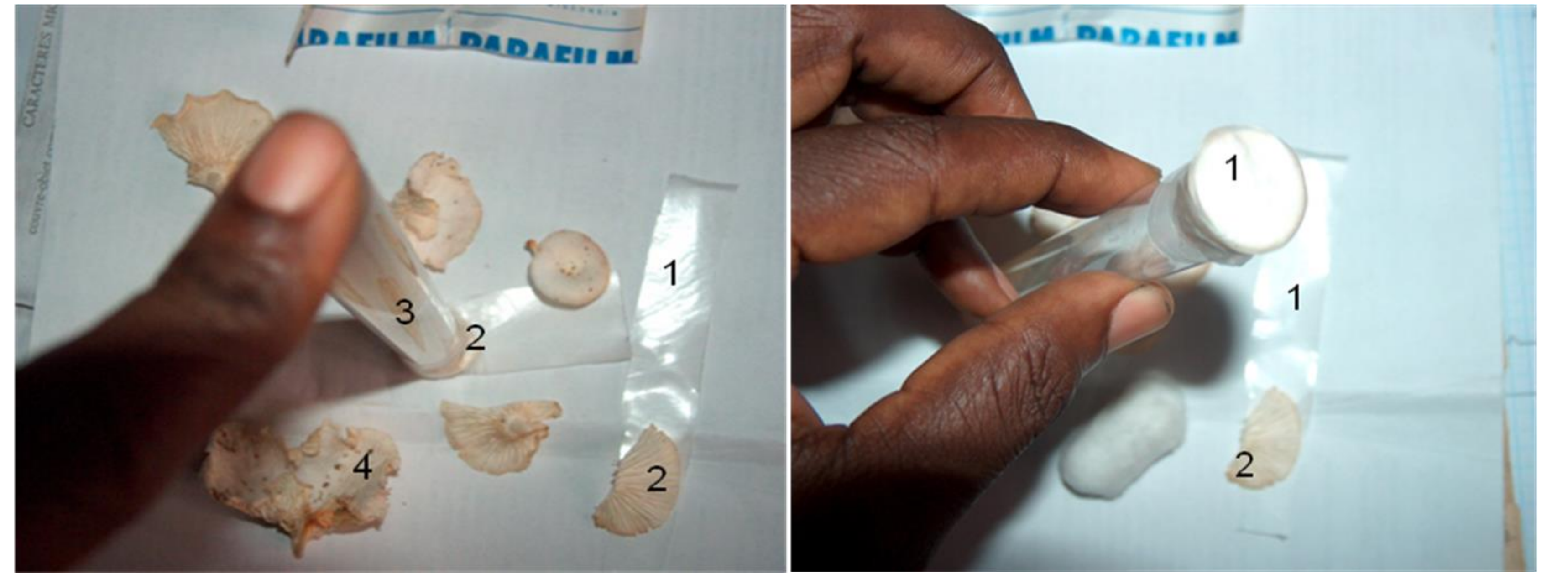
Figure 1. Illustration de la technique d'isolement des souches : 1. papier parafilm, 2. hyménophore (face hyméniale tournée vers l'ouverture de l'éprouvette), 3. éprouvette et 4. sporophore de Marasmiellus inoderma
