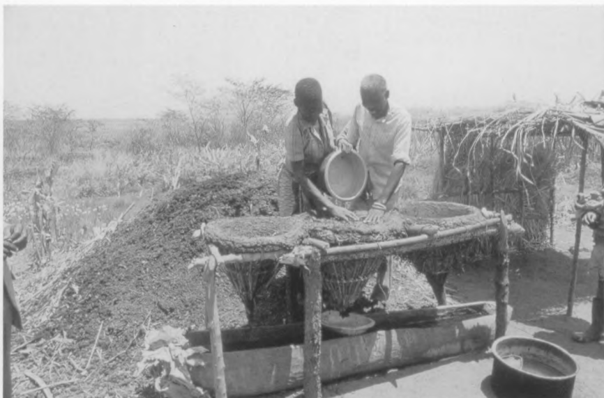
Fig. 17. — Des sauniers versant la première eau dans un filtre katenge ; derrière eux s'élève le tas de terre déjà filtrée (Lushiba, septembre 1993).
