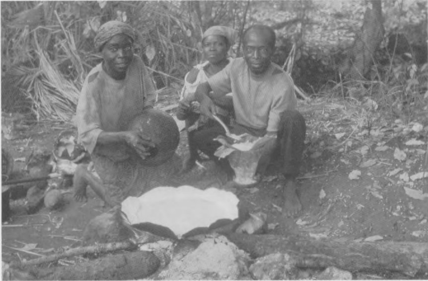
Fig. 10. — Des sauniers travaillant dans la saline de Kisula font évaporer la saumure dans un plat métallique; le sel résultant est ici directement fourré dans un kisense aux parois tapissées de feuilles (normalement, le sel est entreposé dans un récipient entre ces deux opérations); ce pot sera ensuite mis au feu pour agglomérer le cône de sel (photo de Paul Kijika, saline de Kisula, août 1997).
