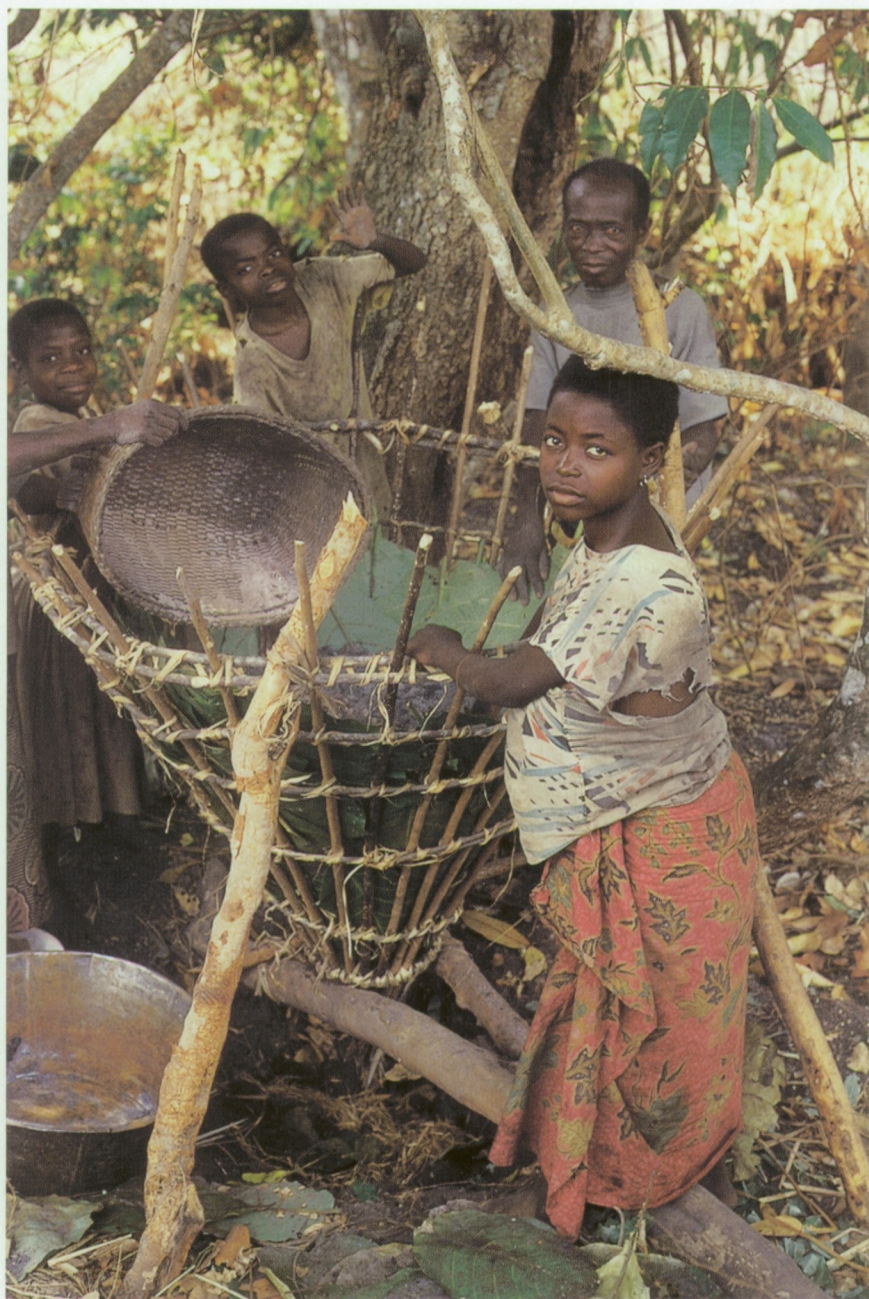
Fig. 6. — Les cendres de la cuisson sont versées dans un filtre lusuku (photo de Paul Kijika, saline de Kisula, août 1997).
