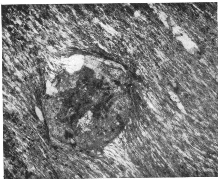
Microphotographie 28 lame E 14 / affl. 23 Phyllite muscovite-chlorite pauvre en quartz; sections hexagonales remplies par un fin agrégat quartz-chlorite ou par de grosses paillettes de chlorite. Lumière naturelle blanche \times 22
