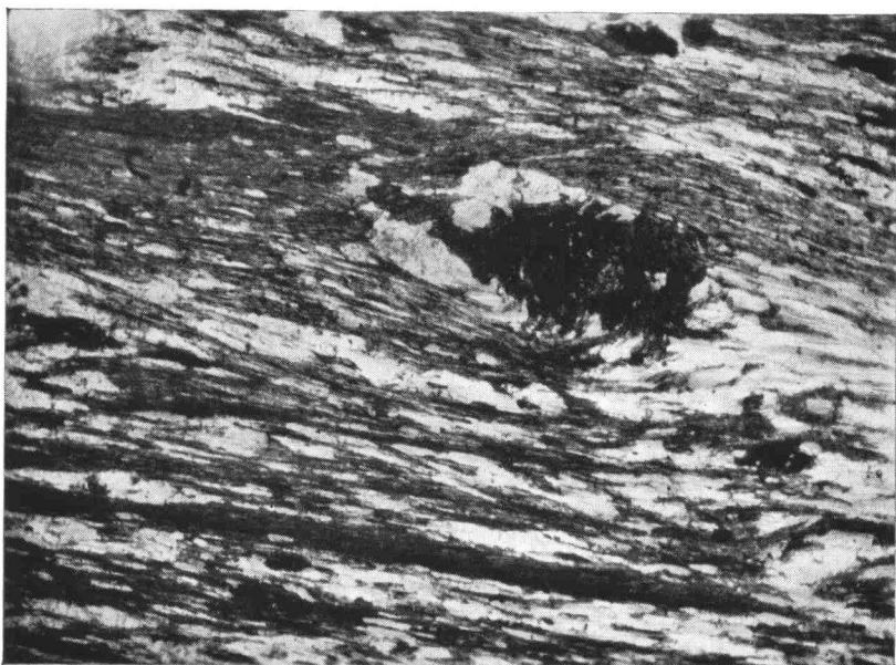
Microphotographie 9 lame E 26 / affl. 59 Schiste quartz-muscovite-chlorite grenatifère ; nodule formé par un petit cristal de grenat, emballé dans de la chlorite. Lumière naturelle blanche \times 22
