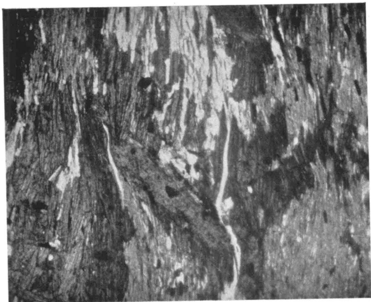
Microphotographie 31 lame E 16 / affl. 27 Phyllite muscovitique microcristalline à nombreuses grosses lamelles orientées de biotite verte, transformée par places en chlorite. Lumière naturelle blanche \times 22
