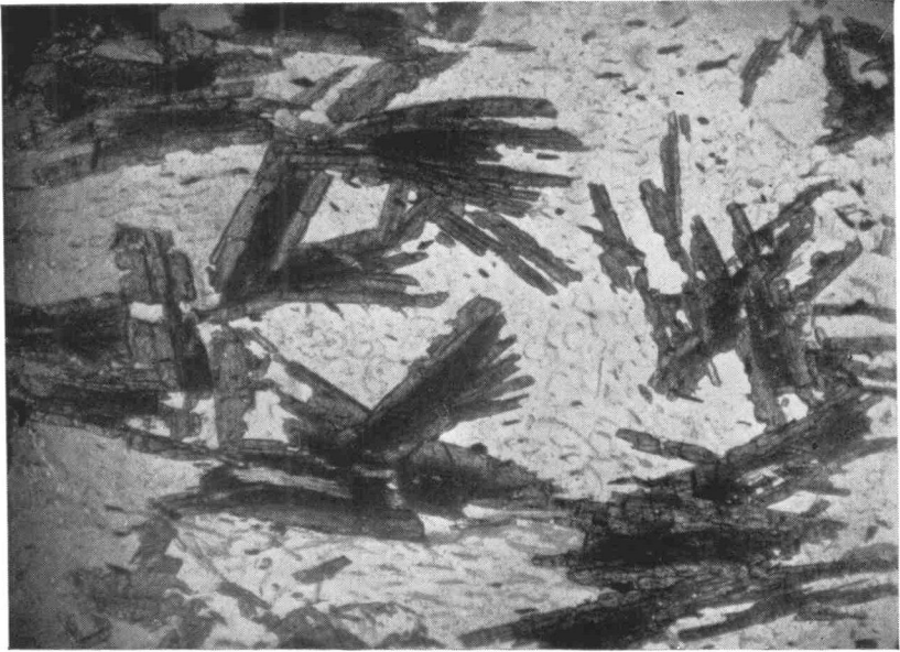
Microphotographie 19 lame E 52 / affl. 177 Quartzite très pauvre en éléments phylliteux, à gros chloritoïde, de la crête Kansanse. Chloritoïde à disposition lamello-radiaire et à structure en sablier. Lumière naturelle blanche × 22
