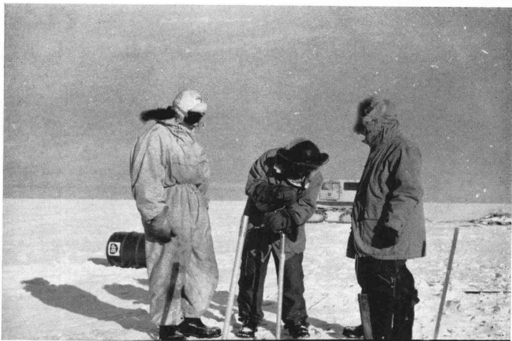
PHOTO 1. — Forage des trous à l'aide de la tarière « Sipre ».
