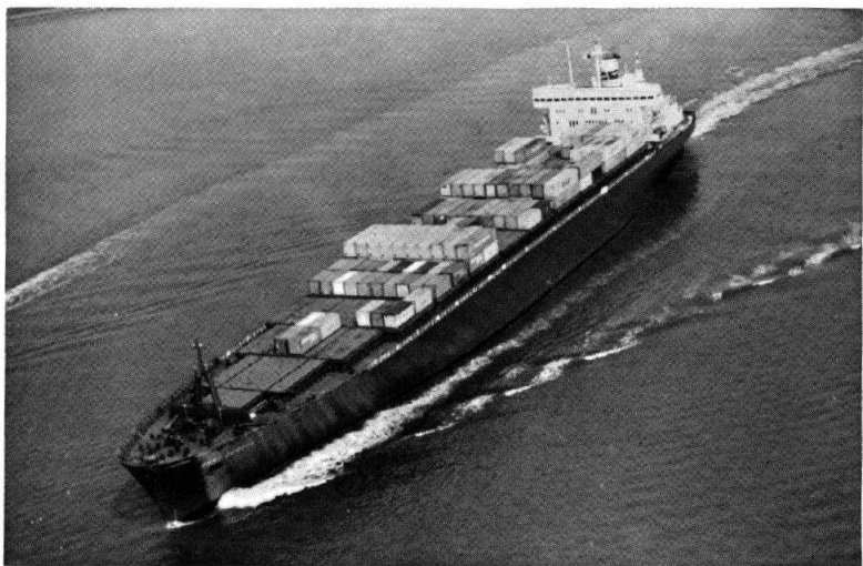
Photo 7 — Le M.S. Dart Europe, d'une capacité de 1556 conteneurs de 20 pieds, construit en 1970.
