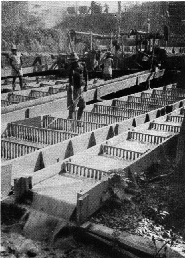
Traitement d'un concentré de sluicing dans une laverie à criblage mécanisé.
