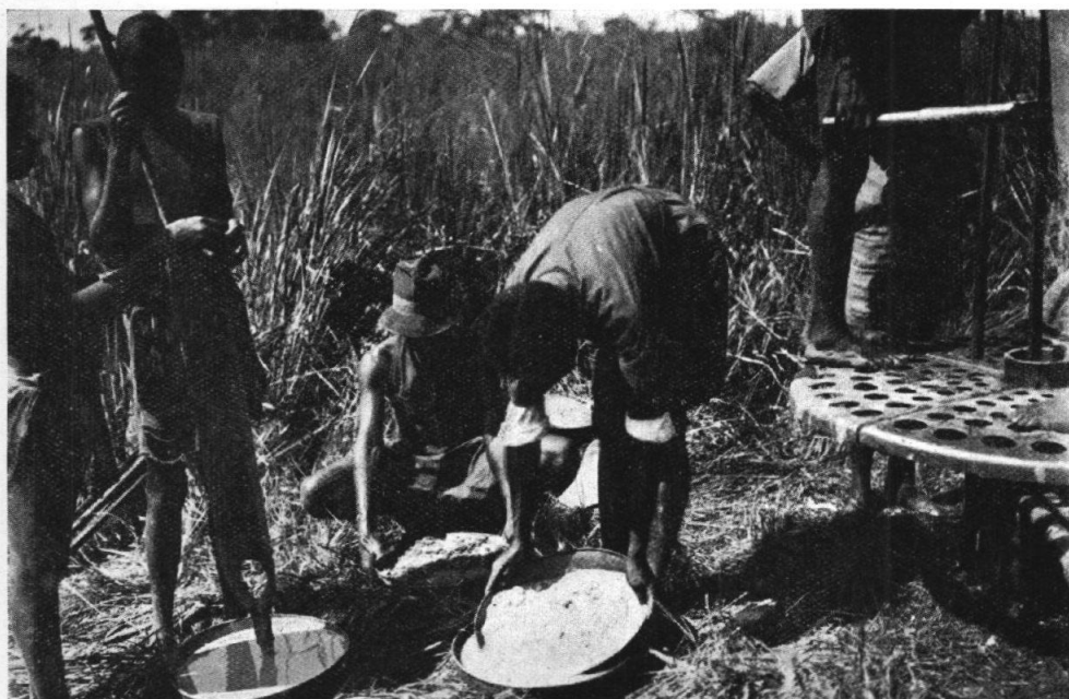
FIG. 21. — Photo 7. Vidage de la pompe à sable dans un pan et pannage immédiat du contenu.
