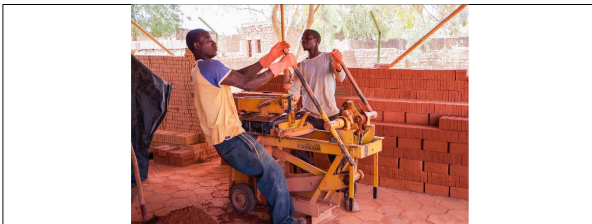
Figure 4. Fabrication des Briques de Terre Comprimée à l'usine Zi-Matériaux à Ouagadougou (d'après l'auteur, 2017) – Presse à main de type TESTARAM
